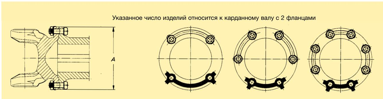
Двойные предохранительные шайбы не относятся к комплектам для фланцевых резьбовых соединений и поставляются только по запросу.
